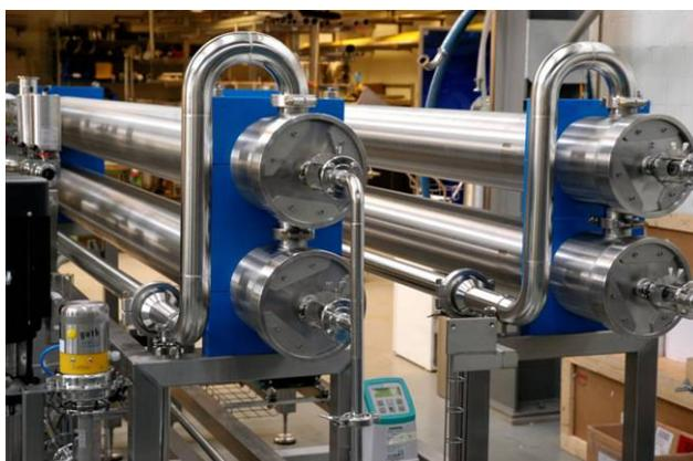
Система **MMS SwissFlow UF** позволяет перерабатывать сыворотку в ценные белковые концентраты. Установки рассчитаны на концентрирование для производства WPC 40 без этапа диалфильтрации до 25% содержания сухих веществ
