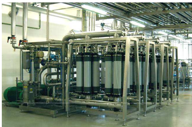
Anlage zur Produktklärung für 5000 L/h
